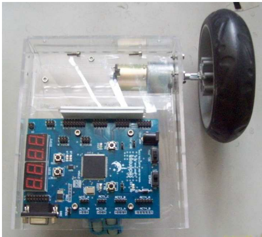
Figura 1. Detalle de ensamble de la rueda, motor y tarjeta de control
