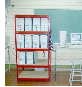
Figura1: Clúster Linux “Colmena” instalado en la UABC
