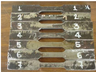
Figura 1. Muestra típica de sección rectangular para el ensayo de tensión-deformación
