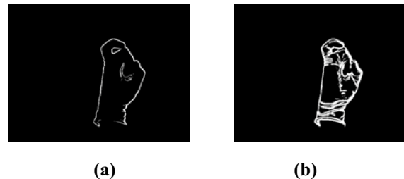
Figura 13 a). Segmentación con CAM. Figura b). Segmentación con el operador SOBEL.
