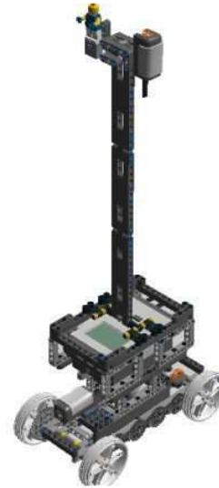
Figura 3. Modelo ensamblado para el control de posición de péndulo invertido sobre la plataforma LEGO MINDSTORMS®, digitalizado en LEGO digital designer.
